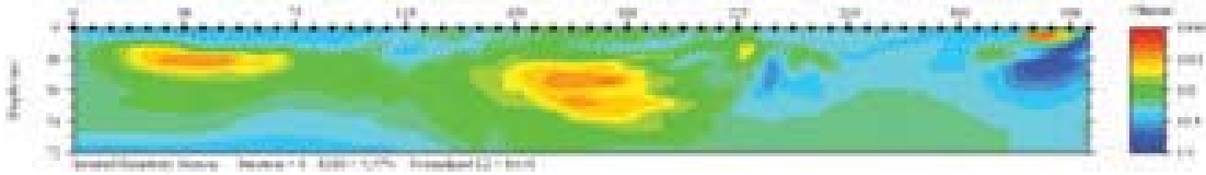
Açık işletme kömür sahası Kemerburgaz. 2D ERT- UBM Koyu sarılar kömür damarı, Koyu mavi, su bendinden sızan su
